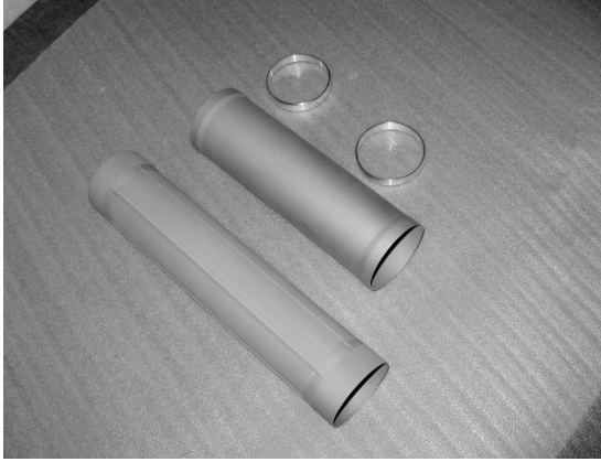
图1 西北稀有金属材料研究院为第三代北京谱仪生产的薄壁铍管
