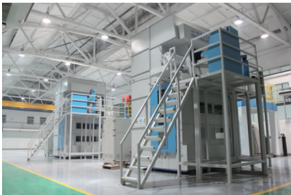
图2 西北工业大学研制的 LSF-V 型激光立体成形与修复再制造商用装备
