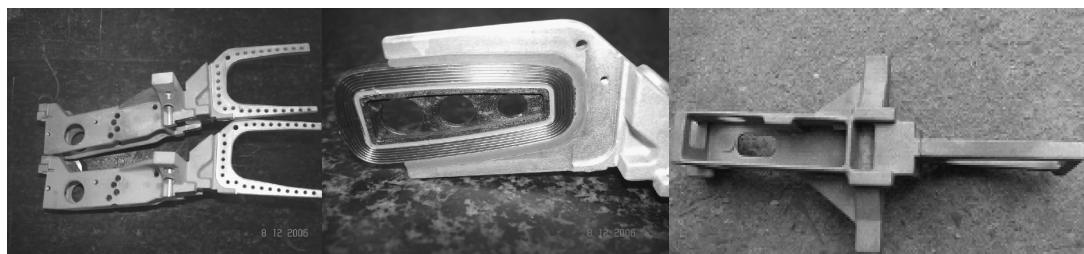
图3 西北稀有金属材料研究院研制的柔性铍铝合金连接件
