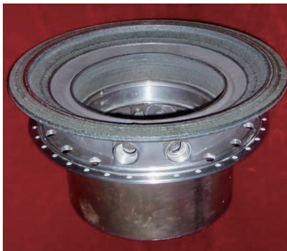
图 3 西北工业大学激光组合制造航空发动机零件
